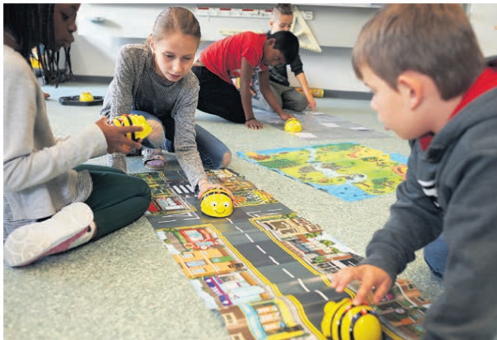
Spielend lernen: Mit vier Knöpfen kann die Fortbewegungsrichtung der Biene programmiert werden.
